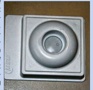
En moins d'une minute le test livre son résultat. Négatif : un rond ; positif : deux ronds.
